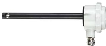
La sonde de vitesse de l'air Série AVU est idéale pour un large éventail d'applications de mesures de CVC et de contrôle, en particulier dans les systèmes intégrés de domotique et de gestion de l'énergie. La série AVU offre une étonnante précision de 5% à bas coût, avec modèles dont les plages de mesures vont de 0-4 à 0-16 m/s, fournissant un signal de sortie de 4-20 mA ou 0-10 VCC.
