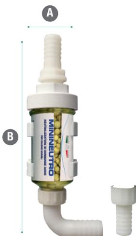
Le condensat produit par les chaudières à condensation est acide, il convient donc de les neutraliser (pour empêcher la contamination et la corrosion des matériaux) et notre mélange de matériaux inertes agit en augmentant la valeur du pH. Un raccord coudé est inclus permettant d'autres installations, supports et ancrages à vis pour pouvoir fixer le système au mur.
