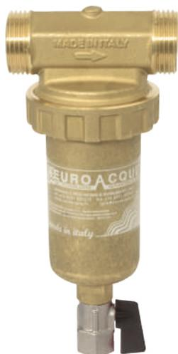
Mini filtres de nettoyage - Filtre de nettoyage collecteur de sable avec tête en laiton, anneau de serrage et récipient. Cartouche en acier inoxydable. Le nettoyage s'effectue grâce au robinet de vidange qui retire le sable sans avoir à démonter le filtre.
