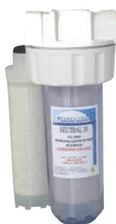
Neutraliseur pour écoulement, permettant le drainage de chaudières grande charge. Équipé d'une charge de filtrage spécifique, double action : ajuste la valeur du pH et bloque les oxydes métalliques.
