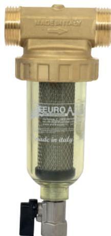
A monter en entrée de réseau. Mini filtres de nettoyage - Filtre de nettoyage de collecteur de sable avec tête en laiton et anneau de serrage. Cartouche en acier inoxydable. Le nettoyage s'effectue grâce au robinet de vidange qui retire le sable sans avoir à démonter le filtre.
