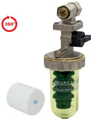
Unité de dosage proportionnel de poudre de polyphosphate préemballée avec raccords ajustables, surélevés de gabarit (rotation par étape 90°) équipés de tiges, soupape de dérivation intégrée à la tête en laiton chromé, écrou d'arrêt pour le récipient, vis de purge. Les raccords sont équipés de 2 tiges avec un système anti bactérien Bios. Sa forme spécifique permet des installations dans des endroits limités. Il est fourni avec une cartouche polyphosphate.
