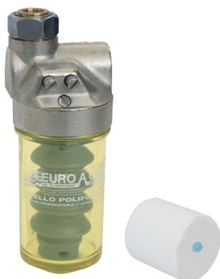
Mini unités de dosage hydrodynamique de cartouches préemballées de poudre de polyphosphate pour eau potable. Tête en laiton. PN 16. Dérivation, régulateur de consommation, vis de purge de ventilation avec tige rotative de sortie avec système antibactérien Bios. Elle est fournie avec une cartouche de polyphosphate.
