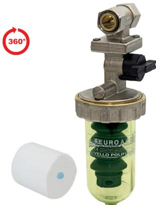
Unité de dosage proportionnel de poudre de polyphosphate préemballée avec raccords ajustables, surélevé de gabarit (rotation par étape 90°) équipés de tiges, soupape de dérivation intégrée à la tête en laiton chromé, écrou d'arrêt pour le récipient, vis de purge. Les raccords sont équipés de 2 tiges avec un système anti bactérien Bios. Sa forme spécifique permet des installations dans des endroits limités. Il est fourni avec une cartouche polyphosphate.
