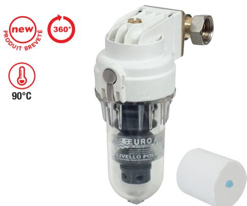
Unité de dosage proportionnel de poudre de polyphosphate préemballée avec raccords réglables (rotation par étape de 90°). Équipée d'un système breveté permettant une purge et une dérivation automatiques en appuyant sur le bouton « clic » en dévissant le récipient.
