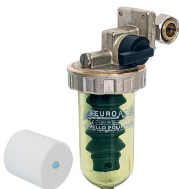
Unité de dosage proportionnel de poudre de polyphosphate préemballée avec raccords ajustables (rotations par palier de 90°), soupape de dérivation intégrée à la tête en laiton chromé, écrou d'arrêt pour le récipient, vis de purge.
