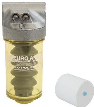
Mini unités de dosage hydrodynamique de cartouches préemballées de poudre de polyphosphate pour eau potable. Tête en laiton. PN 16. Dérivation, régulateur de consommation, vis de purge de ventilation avec système antibactérien Bios. Elle est fournie avec une cartouche de polyphosphate.
